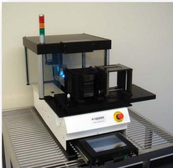
H-Square 社製の AWM 型自動ウエハ移載装置はカセット間のウエハを移載する卓上型ソーターです。
